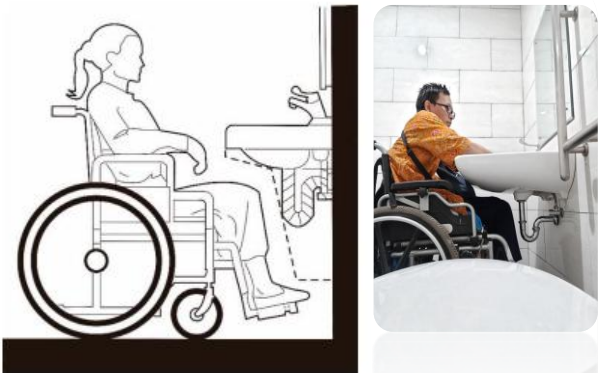
Perletakan bak cuci tangan harus mudah diakses oleh pengguna kursi roda
